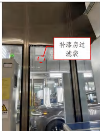
3 间补漆房，每间补漆房设置过滤袋+二级活性炭装置
