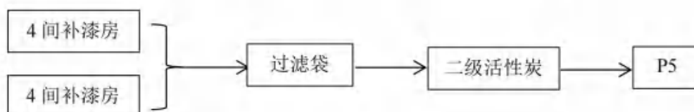
图 2.2.8.1-2 实际补漆房补漆工段环保设施建设情况
