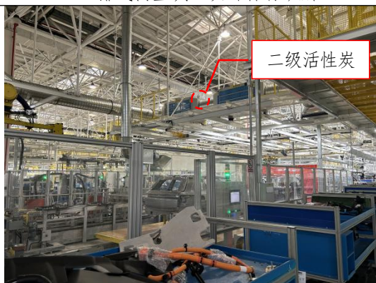
2 条玻璃涂胶生产线各自配备的二级活性炭吸附装置
